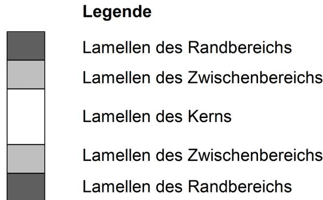
Abbildung 2: Zusammensetzung von kombiniertem Brettschichtholz
