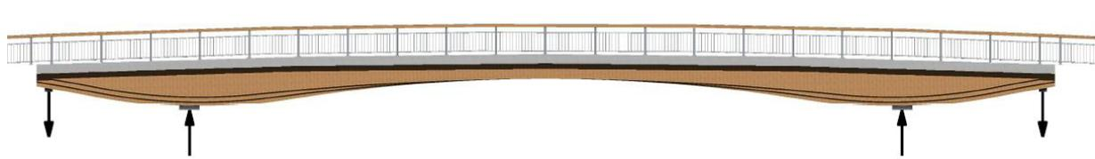
Abbildung 140: Statisches System der Brücke Lohmar (von Miebach [Mie13])
