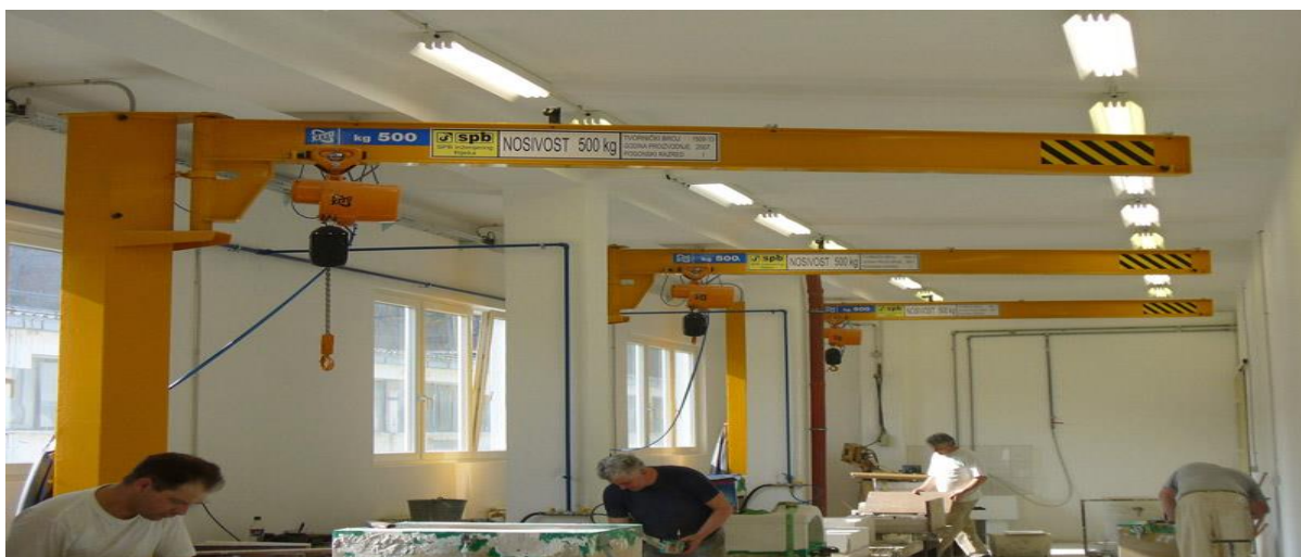
Slika 1.4-Stubna konzolna dizalica nosivosti 500 kg, raspona 3 m
