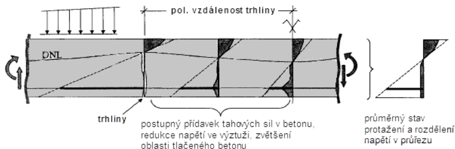
Obr. 2.142: Stav napjatosti při ohybu
