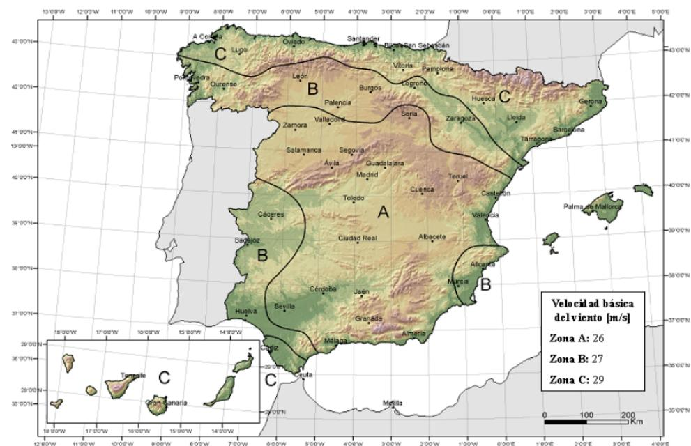
**Figura 6.8.** Presión dinámica del viento, Tabla 3.5 del DBSE-AE.
