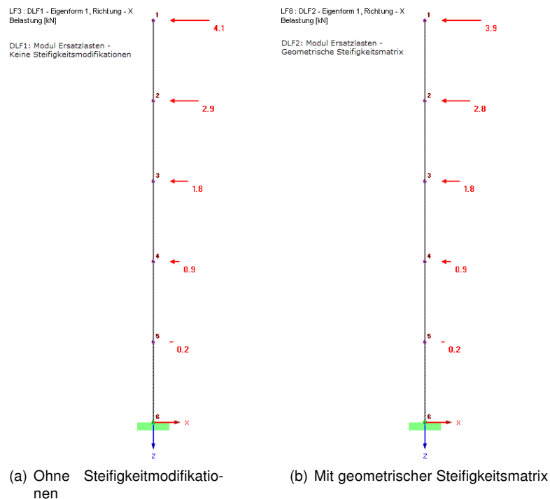
Bild 7: Die Ersatzlasten für die erste Eigenform (a) ohne Steifigkeitsmodifikationen aus dem DLF1 und (b) unter Berücksichtigung der geometrischen Steifigkeitsmatrix aus dem DLF2 .
