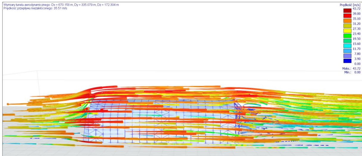
Rys. 4.23. Animacja ukazująca kierunek opływających hangar strug powietrza. Przypadek II. Źródło własne
