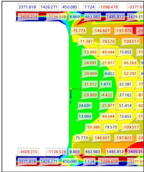
Abbildung 7-17: Ermittlung des FE-Knotens für \tau_{xz} bei x = 0\text{ cm} , Beispiel 2
