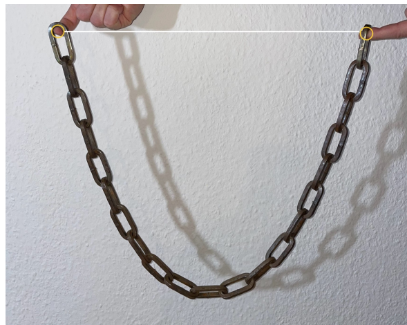
Abbildung 2.1: Darstellung der Kettenlinie am Beispiel einer freihängenden Kette
