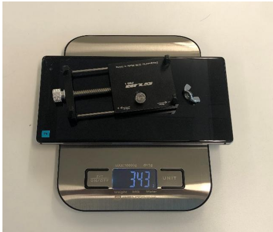
Abb. 4.48: Gewichtsmessung des Smartphones mit der Montagevorrichtung
