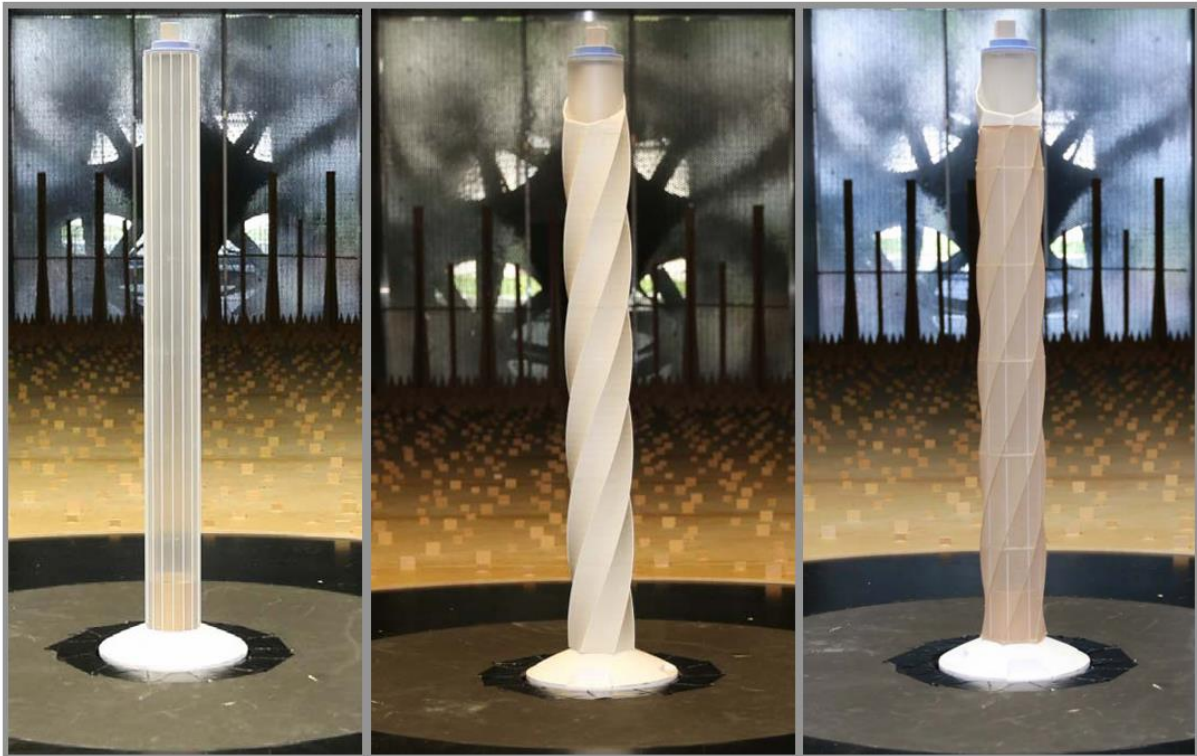
Abbildung 8: Für die Windkanalversuche angefertigten starren Modelle
