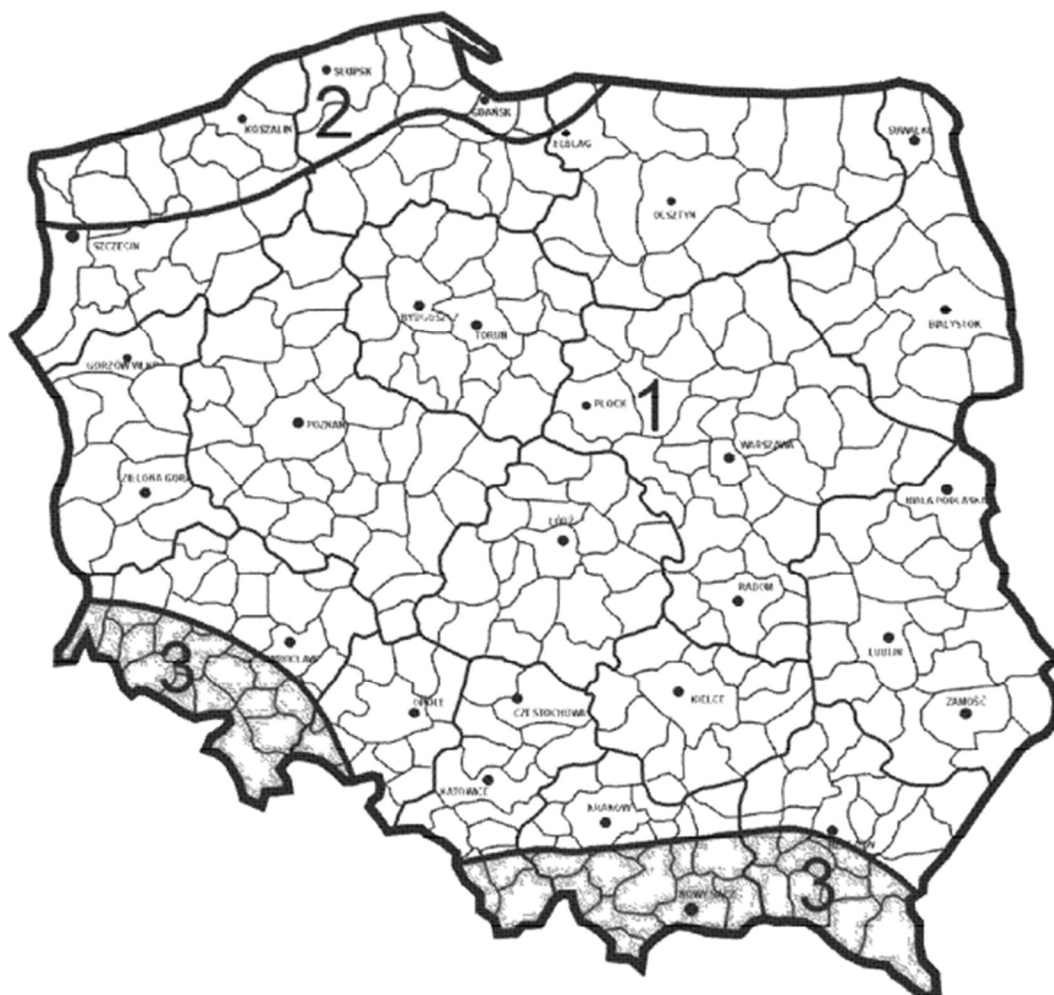
Rys. 4-4 Podział Polski na strefy obciążenia wiatrem
