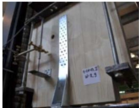
Fig.12.15 Comportamento ciclico di una connessione con hold down
