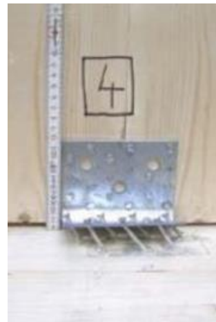
Fig.12.27 Crisi dell'angolare per trazione e scorrimento
