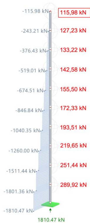
Abbildung 4-63: Variante A - Modell 2 / 10 Geschosse / Eingusssystem / Eigenlast / Stützennormalkraft (blau) & Differenz (rot)
