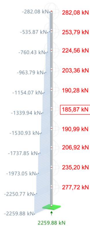
Abbildung 4-64: Variante A - Modell 2 / 10 Geschosse / Bauzustandsanalyse / Eigenlast / Stützennormalkraft (blau) & Differenz (rot)
