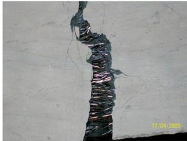
Bild 31: Aktivierung der Nachrisszugfestigkeit (aus [22])
