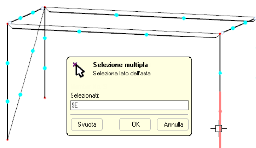
Figura 4.50: Assegnazione grafica dei vincoli interni all'estremità delle aste
