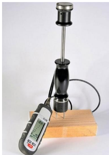
Figura 64 Igrometro a infissione
