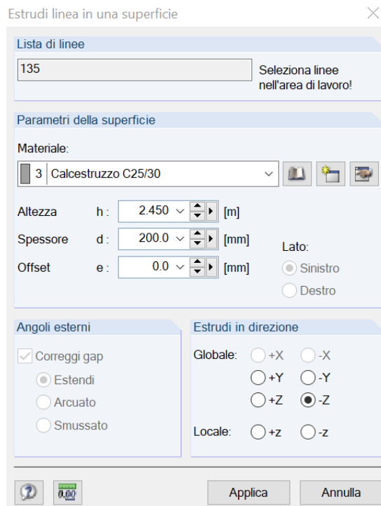
Figura 18 Definizione materiale e dimensioni setti in c.a.
