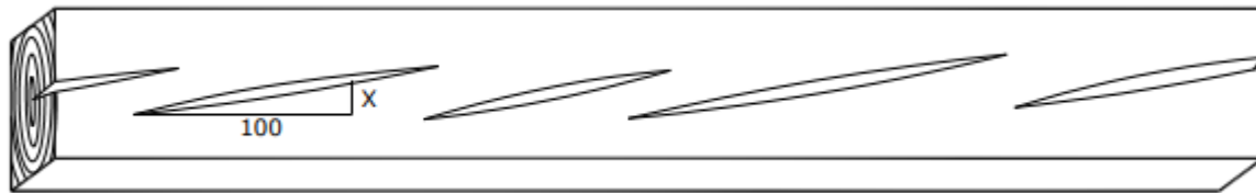
Figura 1.8 Fessurazione longitudinale nella direzione della fibratura del tronco [3].
