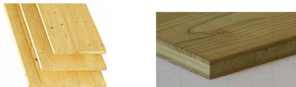
Figura 3.6 Pannelli di legno massiccio monostrato (a sinistra) ed a tre strati (a destra) [7].
