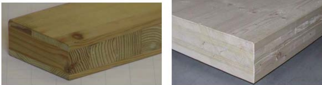
Figura 3.5 Pannelli di legno massiccio a tre strati (a sinistra) e pannello di legno compensato di tavole a cinque strati (a destra) [7].
