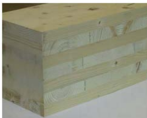
Figura 3.16 Pannello di legno compensato di tavole a sette strati [7].
