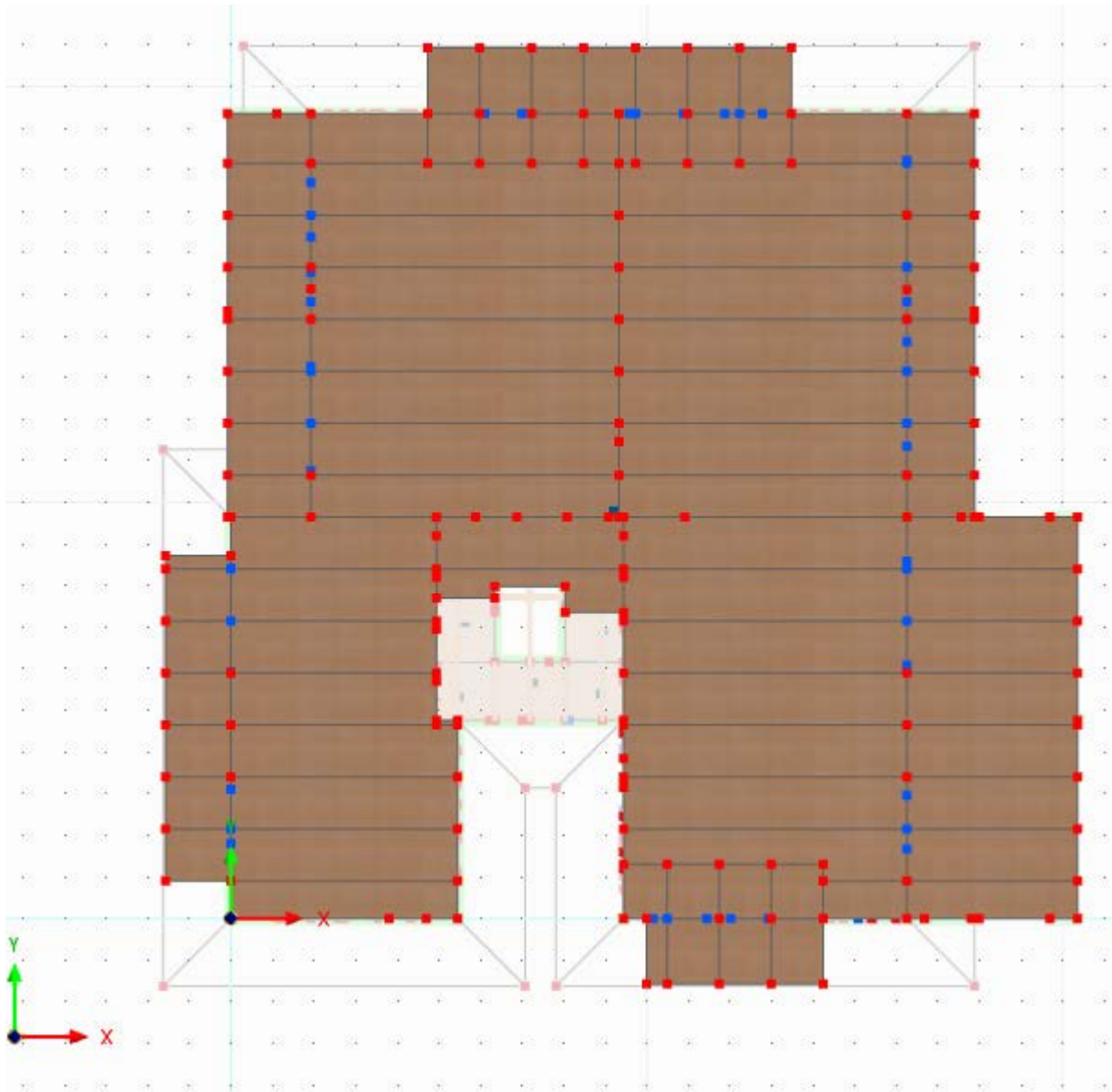
Figura 5.50 Disposizione dei pannelli X-Lam costituenti il solaio.
