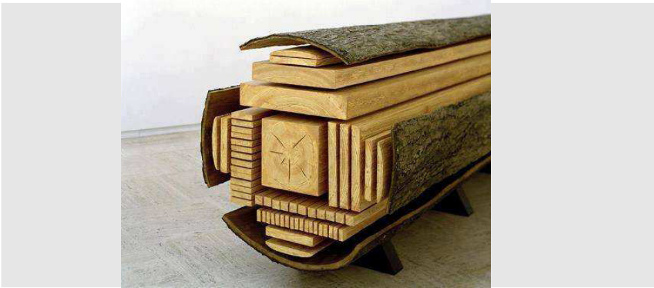
51. Representación de las piezas obtenidas tras el aserrado del tronco del árbol
