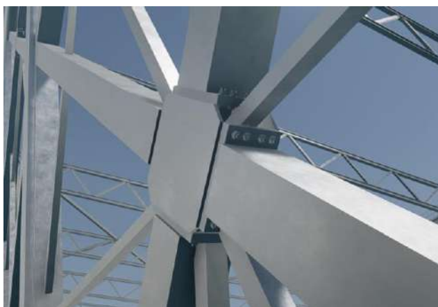
Rys. 3.84. Wizualizacja węzła stężeń zewnętrznych w programie Tekla Structures
