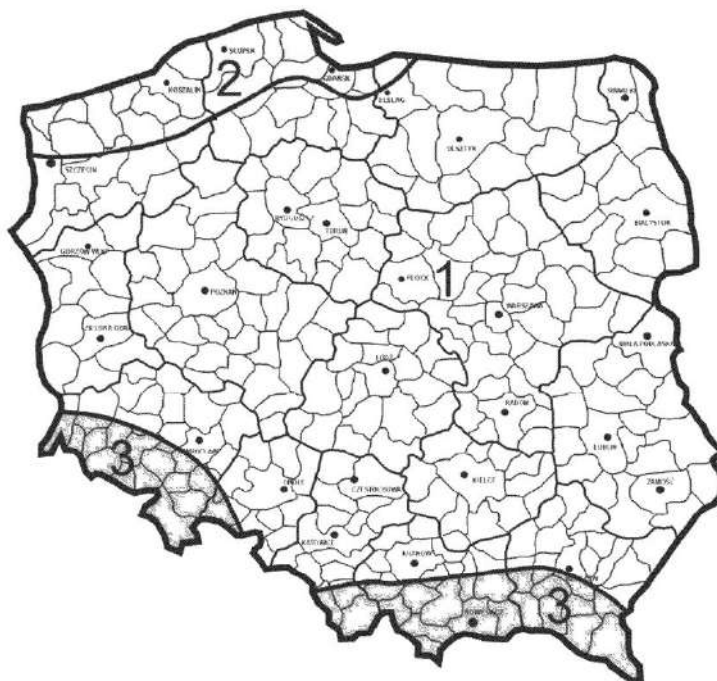
Rys. 3.6. Podział Polski na strefy obciążenia wiatrem, wg [5]
