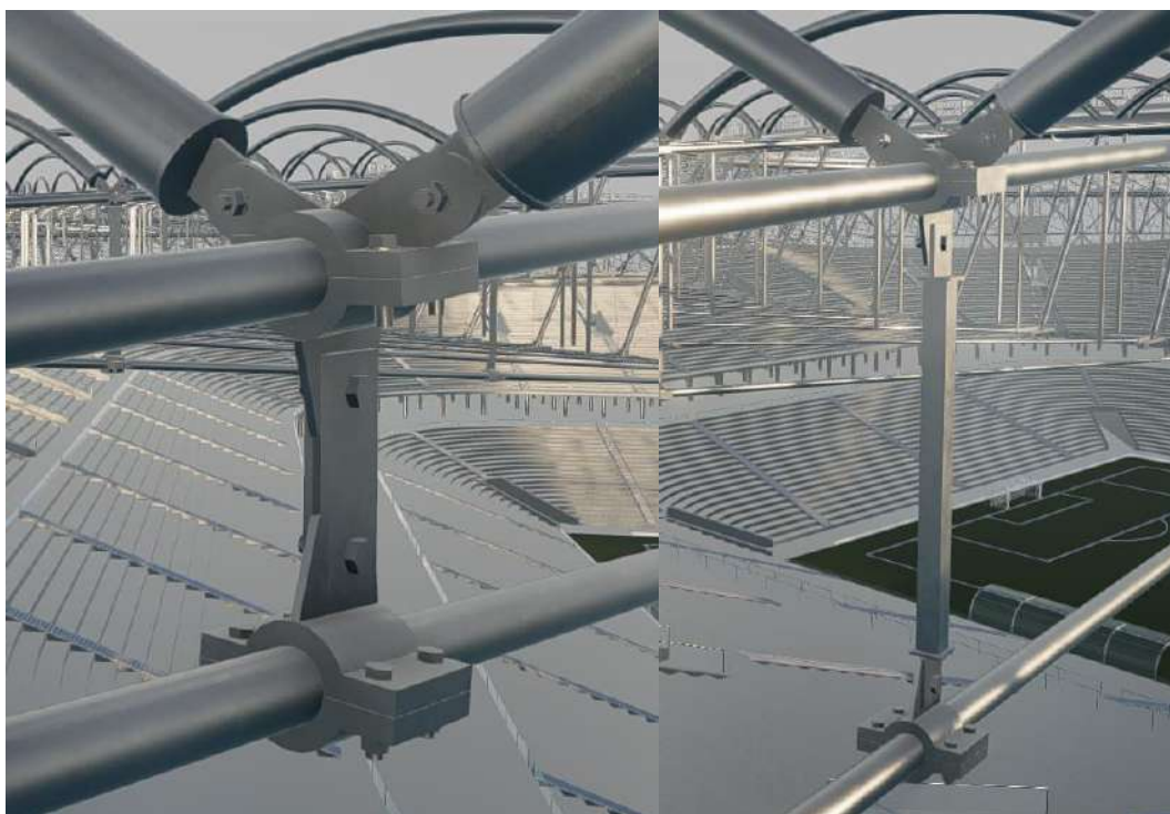
Rys. 3.96. Wizualizacja węzła łączącego rozporowe słupki z cięgnami górnym i dolnym oraz łukowymi profilami, na których oparta będzie membrana – Etap VI
