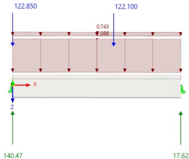
Rys.3.16 Schemat 2 - jedno koło nad podporą, a drugie na belce w odpowiedniej odległości
