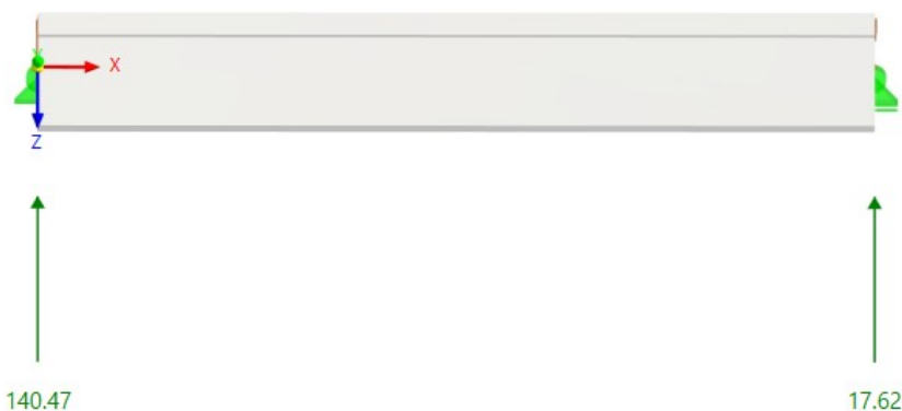
Rys. 3.18 Reakcje podporowe w belce podsuwnicowej od maksymalnego obciążenia w programie RFem.
