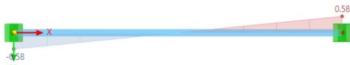
Rys. 4.5 Maksymalna siła tnąca V_{y,d} w programie RFem
