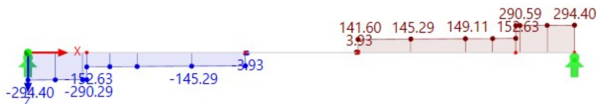
Rys.5.26 Siła tnąca towarzysząca maksymalnemu momentowi skręcającemu
