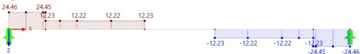
Rys.5.25 Maksymalny moment skręcający w belce krawędziowej
