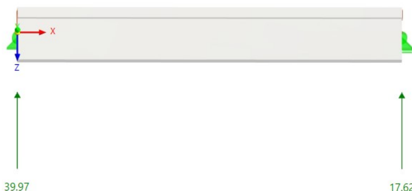
Rys. 3.20 Reakcje podporowe dopełniające w belce podsuwnicowej w programie RFem.
