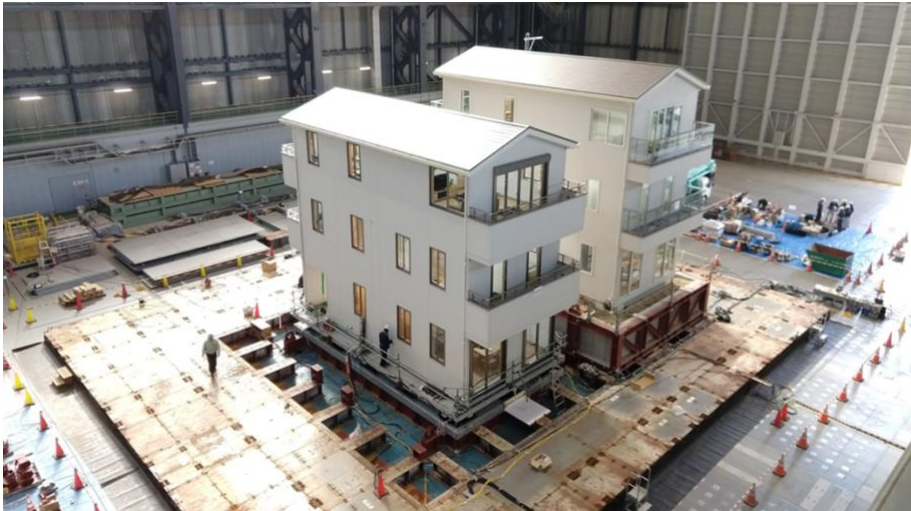
Abb. 3.2: Projekt der Forscher der Texas A&M University am größten Shake-Table der Welt in Japan (Texas A&M University, 2024)
