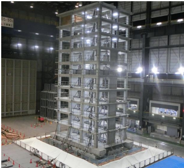
Abb. 1.1: 10-stöckige Stahlbetonkonstruktion auf dem „E-Defense“ Shake Table in Japan (Kobe Convention Bureau, 2024)
