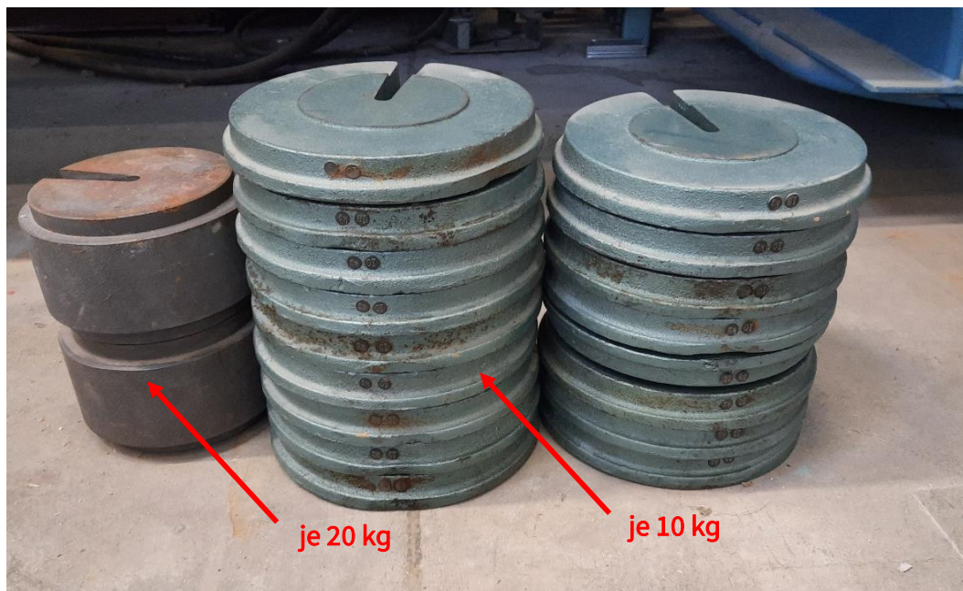
Abbildung 4.2: Gewichtsscheiben für die Belastung der Balken
