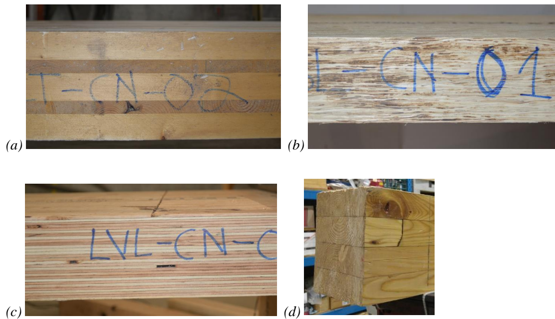
Figure 1-1: EWPs: (a) CLT; (b) LSL; (c) LVL; and (d) GLT (Photo credit Mpidi Bita)
