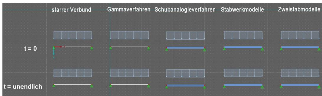
Abb. 41: Berechnungsmodelle für den GZT (Dlubal Software GmbH, 2020)
